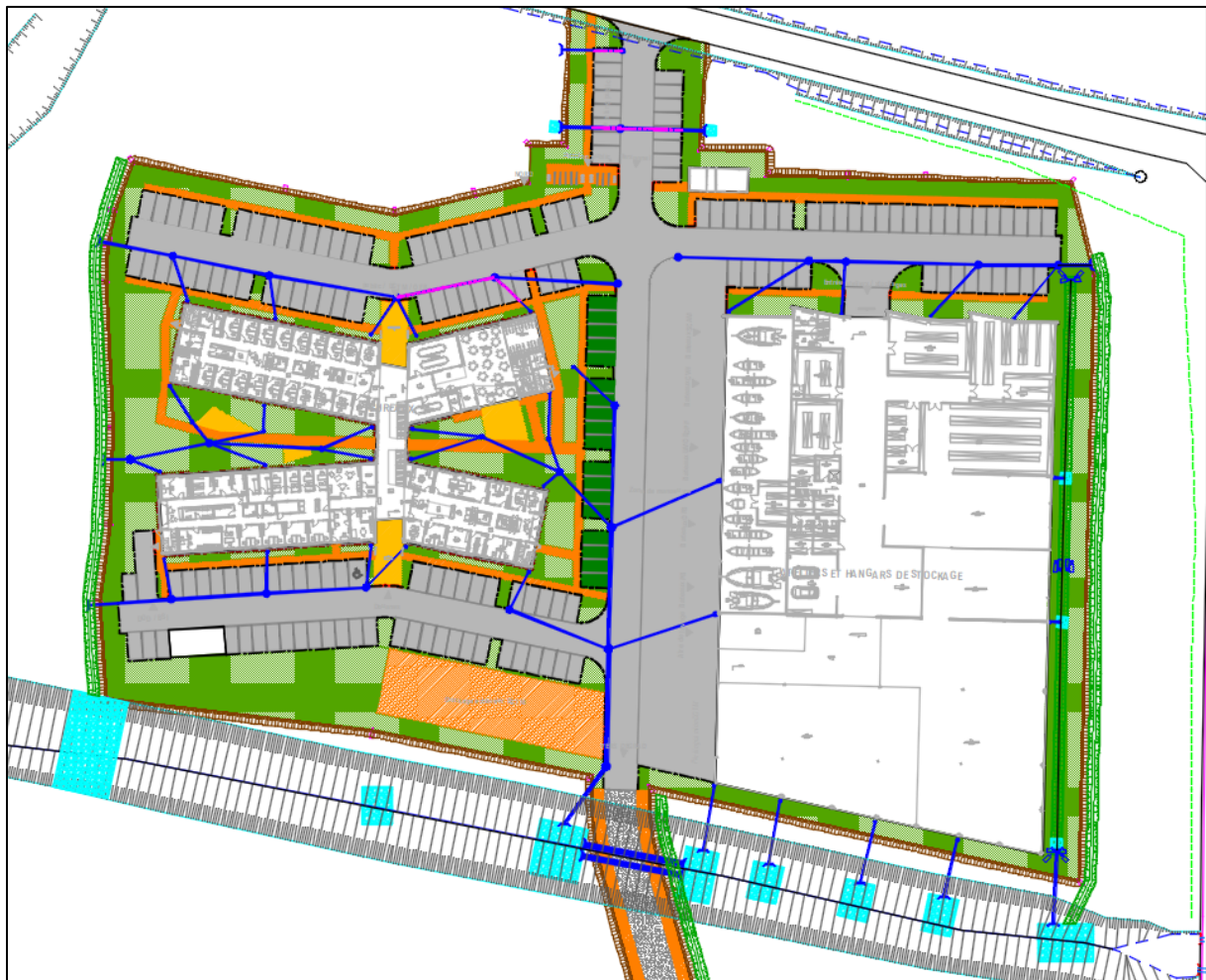
Figure 3. Réseau EP du projet
